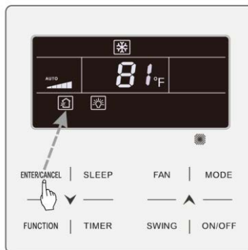
Фиг. 6.11 Включване на функцията Пресен въздух във Фаренхайт
