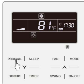
Фиг. 6.8 Задаване на време за вкл./изкл. при включена система по скала на Фаренхайт.
