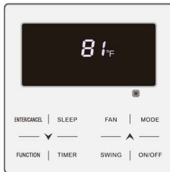
Фиг. 6.4 Интерфейс на изкл. състояние във Фаренхайт
